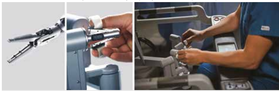
Operátor sedí pri ovládacej konzole a na diaľku ovláda distálne časti nástrojov prostredníctvom vysoko citlivých, na jednotlivých prstoch navlečených joystickov.
